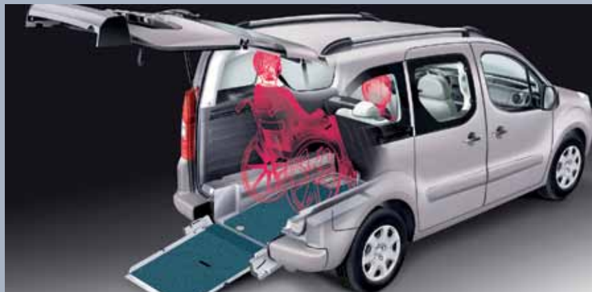
(A) Bei einer Rollstuhlbeförderung werden die original vorhandenen Sitze bzw. Doppelsitzbank nach vorne geklappt bzw. herausgenommen.
